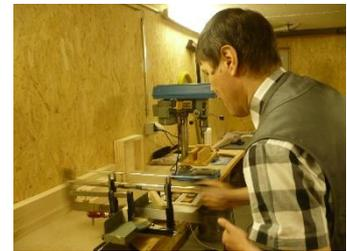
Im nächsten Schritt werden die Löcher gebohrt. Dazu wird jede Leiste immer wieder aus der Halterung genommen und gedreht, damit auch alle notwendigen Löcher an den richtigen Stellen vorhanden sind.
