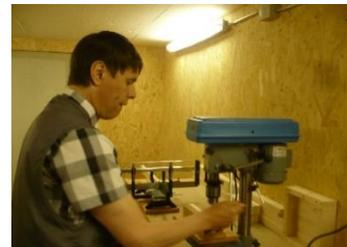
Sind die Löcher gebohrt werden anschliessend die Holzdübel in Leim getaucht, auf die richtige Position gesetzt und mit dem grossen Holzhammer eingeschlagen.
